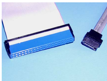
Conectores ATA-6 y SerialATA
