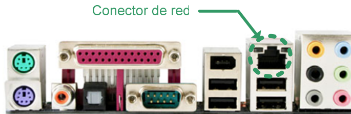
Figura 4: Conectores del panel posterior
