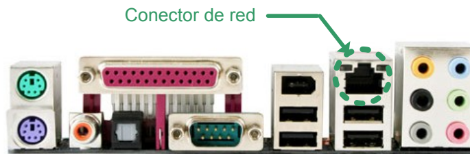
Figura 4: Conectores del panel posterior
