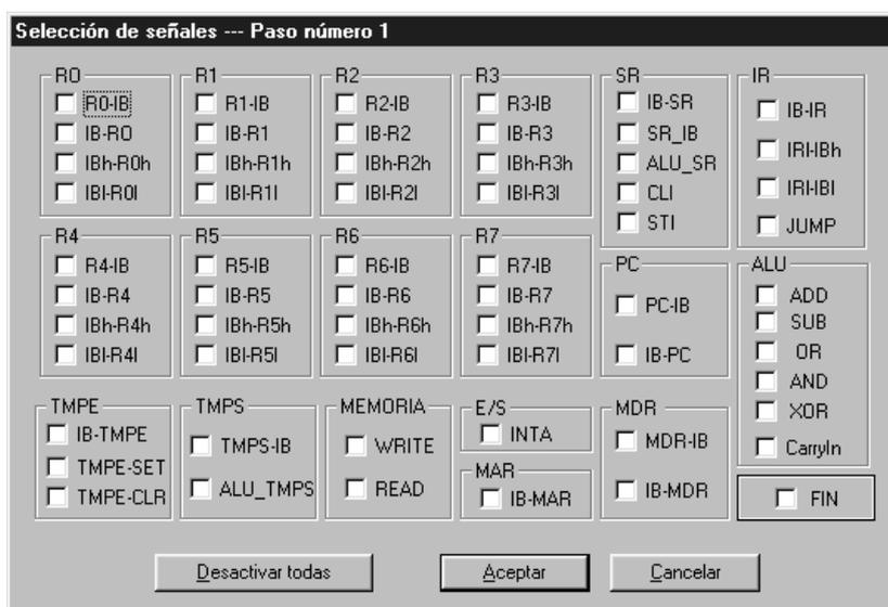
Figura 4.2: Selección de señales en modo de funcionamiento manual
