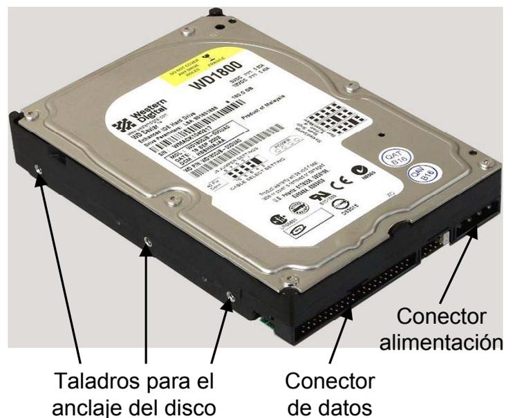
*Las fotografías superiores muestran un disco duro real. Se trata de un modelo típico para PC. Tiene un diámetro de 3,5'', que es el mismo que un disquete. Se monta mediante tornillos en el bastidor interno de la caja y se conecta mediante un cable, usando su conector de datos, a una interfaz interna del computador que lo integra en el sistema de buses, para que pueda comunicarse con la CPU, memoria, etc.*
