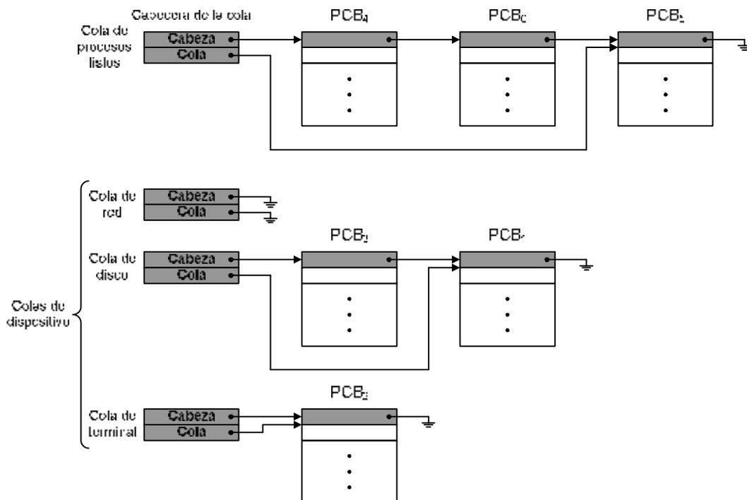
*Las colas se forman enlazando mediante punteros los PCBs de los procesos. El primer campo del PCB es un puntero que se usa para formar estas colas.*
